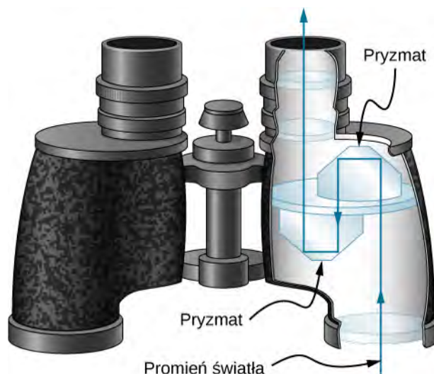
Rysunek 1.18 W lornetce użyte są pryzmaty narożne wykorzystujące zjawisko całkowitego wewnętrznego odbicia, dzięki czemu światło dociera do oczu obserwatora.
