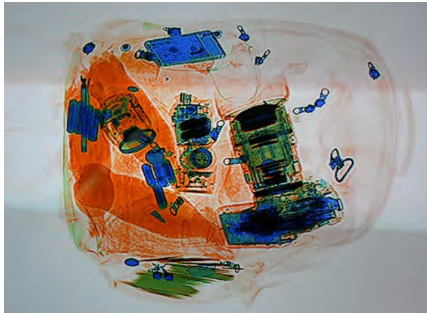
Rysunek 8.26 Obraz rentgenowski bagażu. Im gęstszy materiał, tym ciemniejszy cień. Kolory przedmiotów odnoszą się do składu materiałów np. obiekty metalowe wyświetlane są jako niebieskie. Źródło: „IDuke”/Wikimedia Commons
