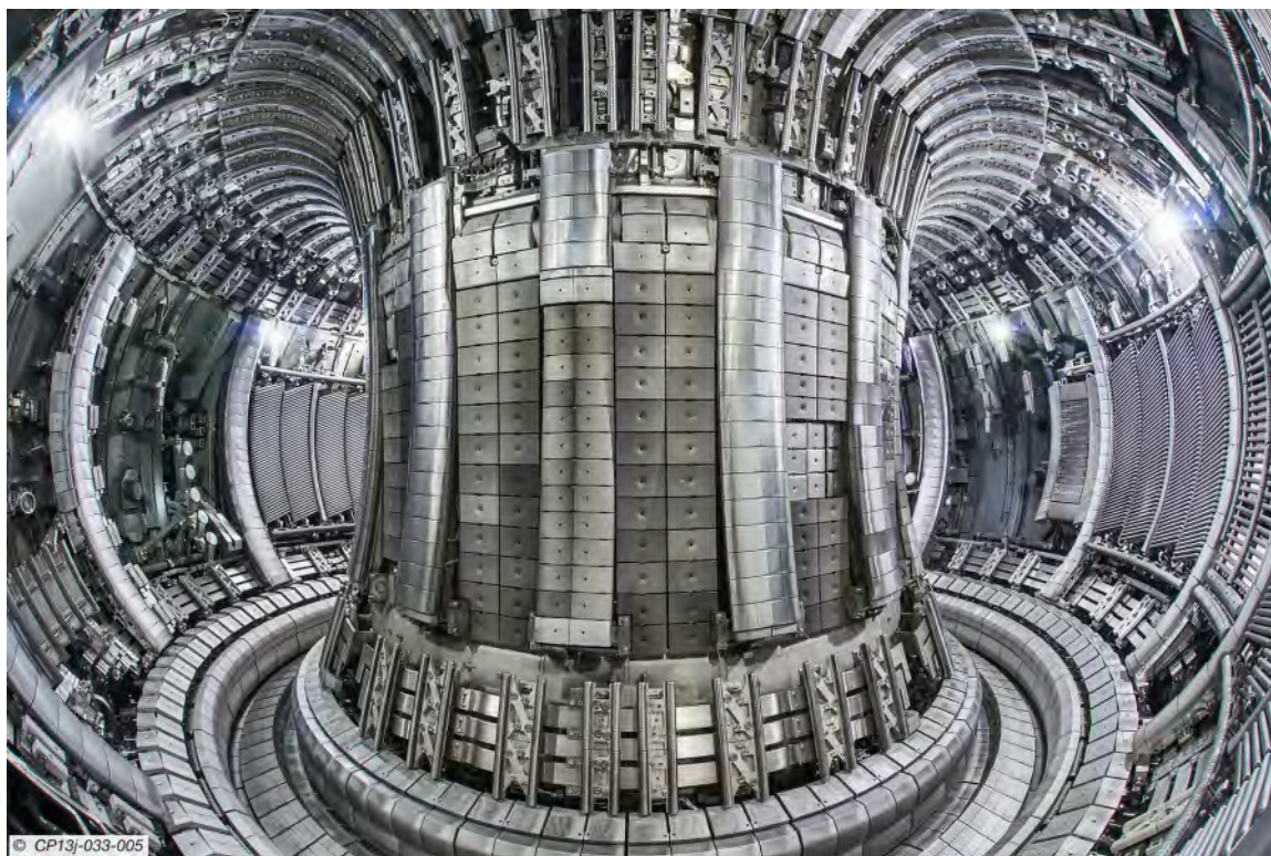
Rysunek 10.25 Tokamak w reaktorze termojądrowym Joint European Torus (JET) wykorzystuje pole magnetyczne do utrzymywania jąder deuteru i trytu w czasie fuzji jądrowej. Źródło: EUROfusion
