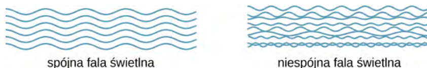
Rysunek 8.29 Spójna fala świetlna zawiera fale o tej samej częstotliwości i tej samej fazie. Fala niespójna składa się z fal o różnych częstotliwościach i różnych fazach.
