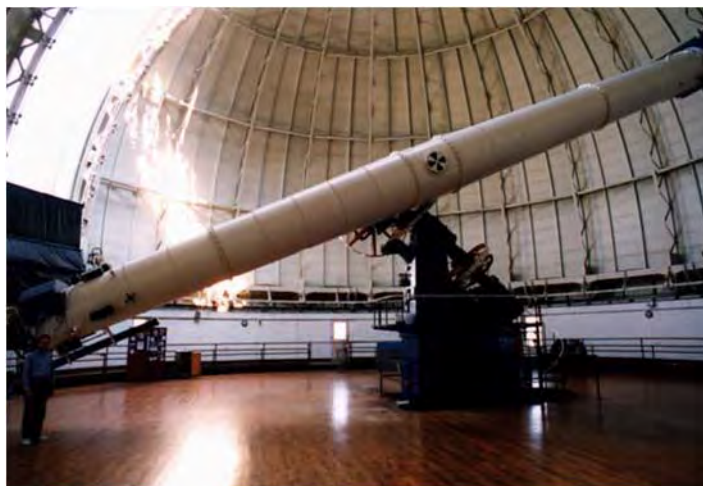
Rysunek 2.43 W 1897 roku Obserwatorium Yerkesa w Wisconsin (USA) zbudowało duży teleskop refrakcyjny z obiektywem o średnicy wynoszącej 40 cali i długości tuby 62 stopy. Źródło: Obserwatorium Yerkesa, Uniwersytet Chicago
