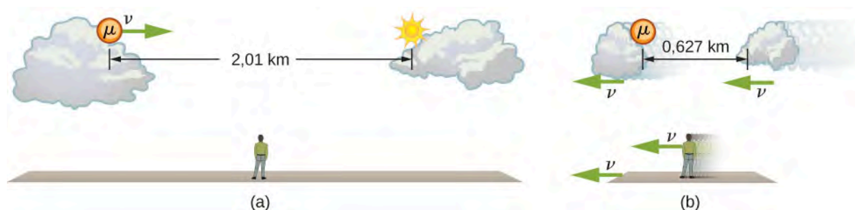
Rysunek 5.9 (a) Obserwator znajdujący się na Ziemi rejestruje przemieszczenie się mionu równe odległości 2,01 km. (b) Ta sama droga ma długość 0,627 km, gdy jest obserwowana z układu odniesienia mionu. Otoczenie (Ziemia, powietrze i chmury) porusza się względem mionu i ulega skróceniu w kierunku przemieszczenia.
