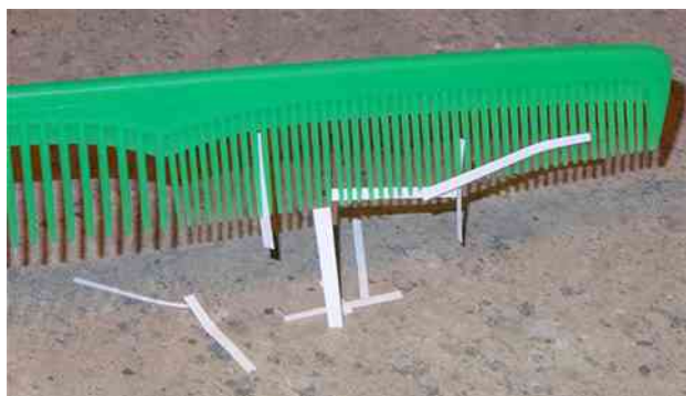
Rysunek 5.3 Grzebień, po tym jak użyliśmy go do czesania, przyciąga małe kawałki papieru na odległość, bez bezpośredniego z nimi kontaktu. Analiza tego zjawiska przyczyniła się do wprowadzenia pojęcia „siły elektrostatycznej”.
