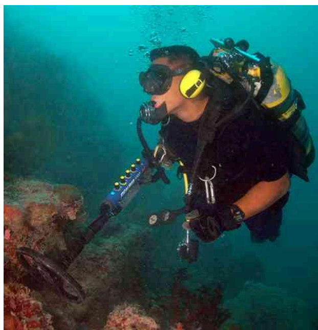
Rysunek 15.19 Kiedy detektor znajduje się w pobliżu kawałka metalu, samoindukcja jednej z cewek ulega zmianie. To powoduje przesunięcie częstotliwości rezonansowej całego obwodu zawierającego tę cewkę. Zmiana jest wykrywana przez urządzenie i przesyłana do nurka przez słuchawki.
