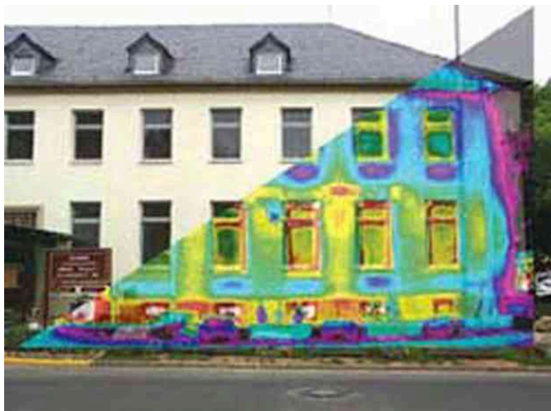
Rysunek 1.32 Termogram części budynku pokazuje wahania temperatury, wskazując miejsca, w których ciepło jest przekazywane na zewnątrz. Okna są głównym obszarem przekazywania ciepła na zewnątrz domów. Źródło: US Army
