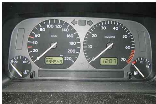
Rysunek 10.34 Wskaźnik poziomu paliwa (pierwszy z lewej) i wskaźnik temperatury (pierwszy z prawej) w tym volkswagenie z 1996 r. są w rzeczywistości woltomierzami, w których rejestrowane napięcie wyjściowe przeliczane jest na odpowiednie jednostki. Są one proporcjonalne do ilości benzyny w zbiorniku lub temperatury silnika. Źródło: Christian Giersing
