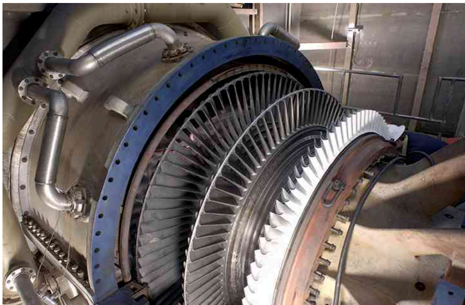
Rysunek 13.31 Turbina parowa wraz z generatorem. Para wodna, wytwarzana przez spalanie węgla, uderza w łopatki turbiny i obraca jej wałem sprzężonym z wałem generatora.
