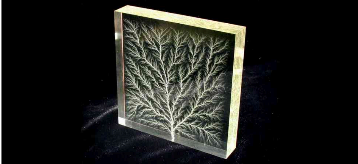
Rysunek 8.1 Wzory przypominające rozgałęzione drzewo wewnątrz przezroczystej płyty ze szkła akrylowego, nazywane figurą Lichtenberga dla upamiętnienia Georga Christoha Lichtenberga (1742–1799) , który badał je jako pierwszy. Powstają one w wyniku uszkodzenia struktury dielektryka przez silne pole elektryczne. Źródło: modyfikacja pracy Berta Hickmana
