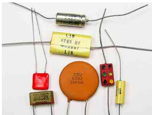
Rysunek 8.4 Oto kilka typowych kondensatorów. Ich wielkość nie ma bezpośredniego przełożenia na pojemność elektryczną.
