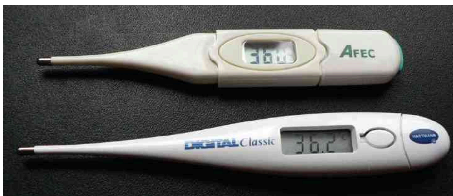
Rysunek 9.17 Te powszechnie używane termometry działają na zasadzie automatycznego pomiaru zależnej od temperatury rezystancji termistora.
