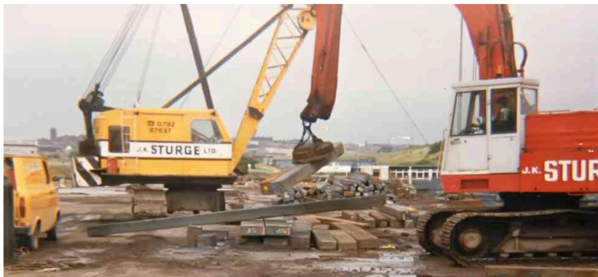
Rysunek 11.1 Przemysłowy elektromagnes może unieść tysiące kilogramów stali. Źródło: modyfikacja pracy „BedfordAI”/Flickr
