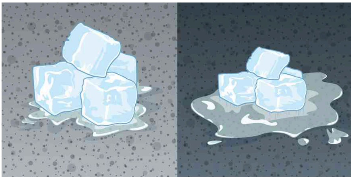
Rysunek 1.30 Ciemniejszy chodnik jest bardziej gorący niż jasny (znacznie więcej lodu ulegnie stopieniu na chodniku z prawej strony), mimo że obydwa są wystawione na promienie słoneczne przez taki sam czas. Przewodności cieplne chodników są takie same.
