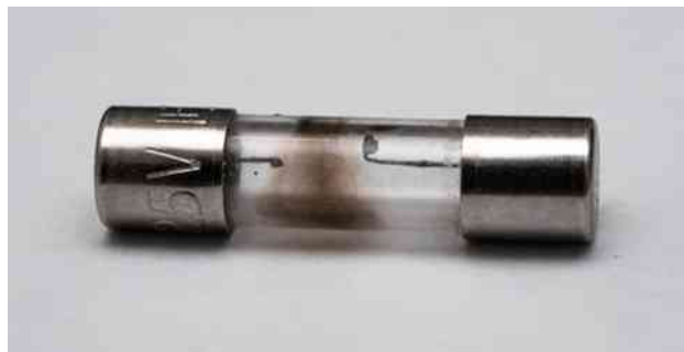
Rysunek 9.25 Bezpiecznik zawiera krótki drucik z dwoma kontaktami. Gdy natężenie przepływającego prądu jest większe niż zadane, drucik się topi, przerywając połączenie. Na zdjęciu przedstawiono przepalony bezpiecznik, w którym zostało zerwane połączenie. Źródło: modyfikacja pracy „Shardayyy”/Flickr
