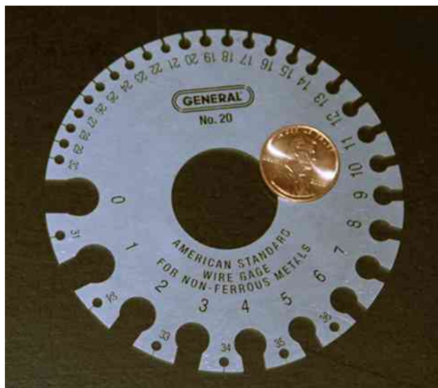
Rysunek 9.11 Przyrząd do pomiaru rozmiaru drutu elektrycznego. Jak można zauważyć, większa wartość AWG oznacza cieńszy drut.
