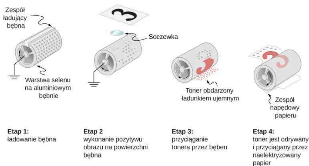
Rysunek 7.42 Kserografia jest metodą suchego kopiowania, opartą na procesach elektrostatycznych. Najważniejsze etapy powstawania kopii kserograficznej są następujące: ładowanie fotorzprzewodzącego bębna, wykonanie pozytywu kopiowanego obiektu na bębnie, naniesienie dodatniego ładunku na pozytyw, przyciąganie tonera do dodatnio naładowanych fragmentów bębna, przeniesienie tonera na papier. Na schemacie nie przedstawiono etapu obróbki cieplnej papieru i oczyszczania bębna przed następną kopią.
