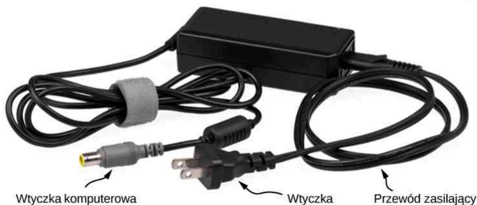
Rysunek 5.9 W tym zasilaczu wykorzystane są przewody metalowe i wtyczki do przewodzenia elektryczności z gniazdka w ścianie do laptopa. Przewodzące druty pozwalają elektronom swobodnie przemieszczać się wzdłuż kabli, które są osłonięte gumą i plastikiem. Te materiały są izolatorami, które nie pozwalają na ucieczkę ładunków elektrycznych na zewnątrz. Źródło: adaptacja pracy „Evan-Amos”/Wikimedia Commons
