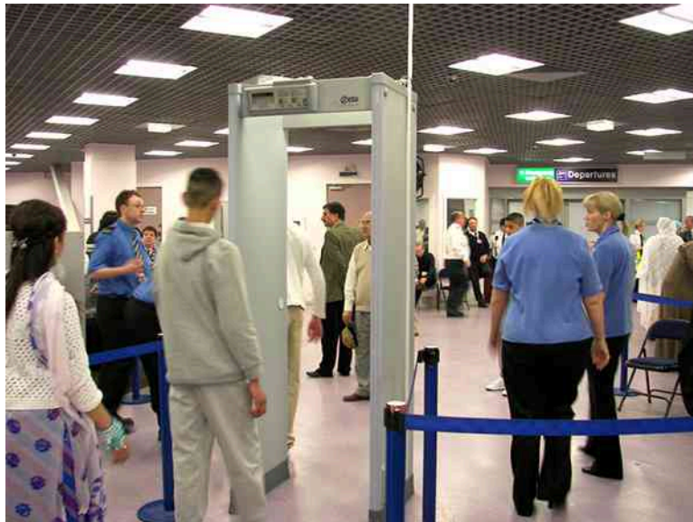
Rysunek 14.9 Bramka bezpieczeństwa na lotnisku może nie tylko wykryć metal przenoszony przez osobę, ale także wskazać jego przybliżoną wysokość nad podłogą. Źródło: „Alexbuidrs”/Wikimedia Commons
