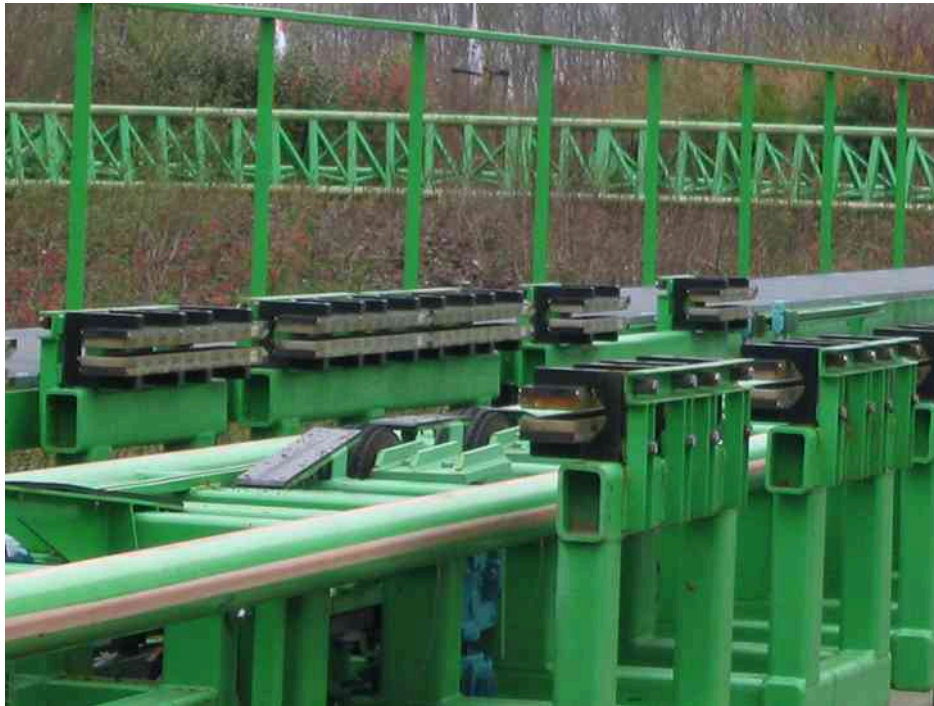
Rysunek 13.26 Poziome rzędy magnesów z pierwiastków ziem rzadkich w systemie magnetycznego hamowania kolejki górskiej. Źródło: Stefan Scheer
