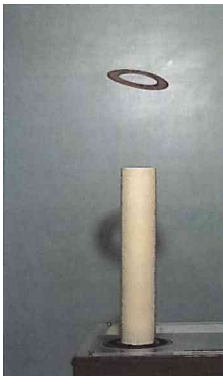
Rysunek 13.10 Skaczący pierścień. Włączenie prądu zasilającego pionowy solenoid powoduje zaindukowanie się w metalowym pierścieniu prądu elektrycznego. Narastające pole magnetyczne solenoidu powoduje wyrzucenie pierścienia z solenoidu.
